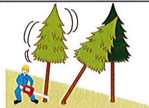
(図4)かかり木に激突させるためにかかり木以外立木の伐倒
