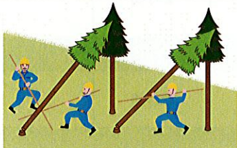
(図2) かかり木の処理
